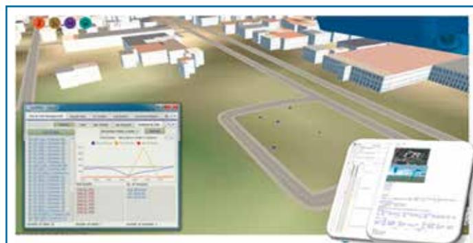
**Figura 5 - Visualizzazione del piano campagna di un sito e dei suoi piezometri di monitoraggio indicati con i puntini blu. A sinistra è visibile il grafico automatico per l'analisi delle acque di falda, a destra il report prodotto in automatico sullo stato delle matrici ambientali del sito.**
