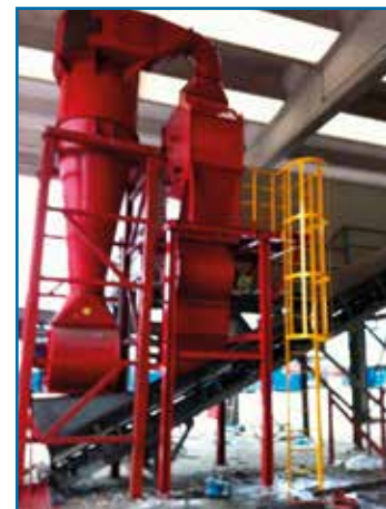
Figura 13 – Separatore aeraulico (Fonte: http://www.sortech.it ).
