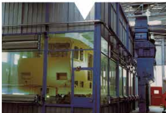
Cabina di verniciatura per vagoni e locomotori ferroviari.
