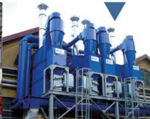
Centrale di aspirazione e captazione di trucioli d'alluminio.
