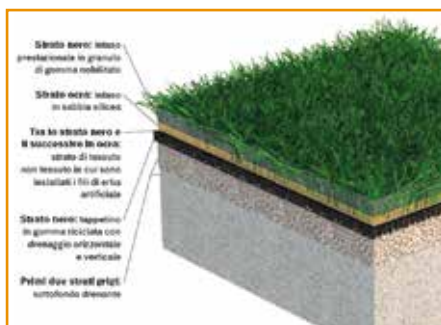
Figura 3 – Stratigrafia di un campo da calcio in erba sintetica.
