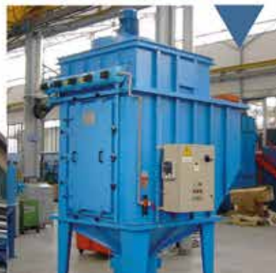
Gruppo filtrante ATEX a cartucce per aspirazione e depolverazione di polveri esplosive.
