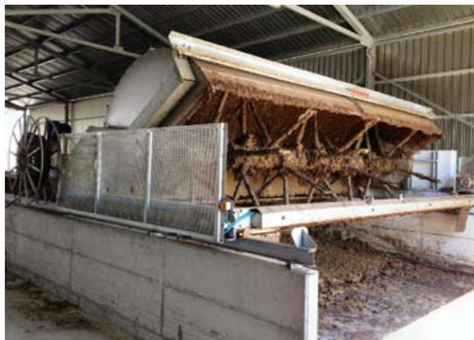
**Figura 2 - Rivoltatore dell'impianto di biostabilizzazione.**
